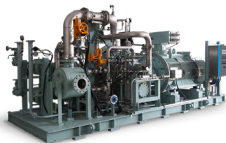
Oljefria gasskruvkompressorer är nödvändig utrustning på LNG-fartyg
